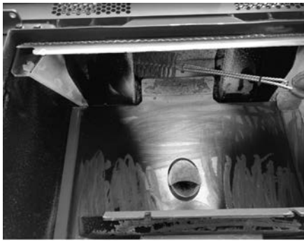
Fig. 111 - Nettoyer avec un goupillon.
