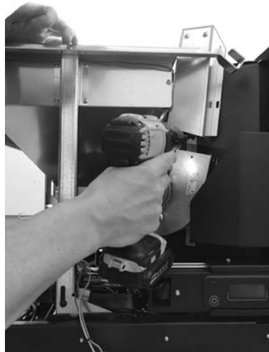
Fig. 50 - Fixer le ventilateur
