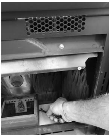
Fig. 107 - Retirer les vis
