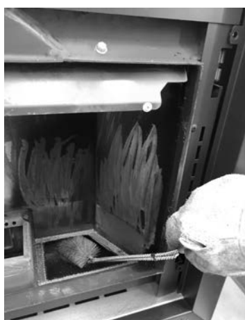
Fig. 109 - Nettoyer avec un goupillon.
