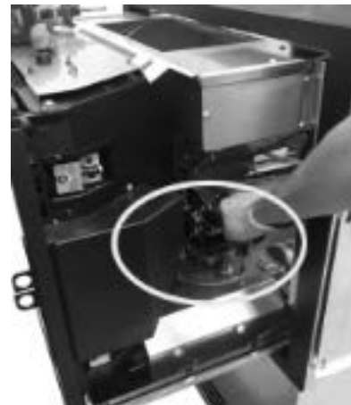
Fig. 104 - Retirer les vis
