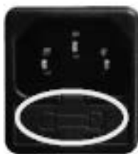
Fig. 123 - Hublot avec les fusibles à enlever
