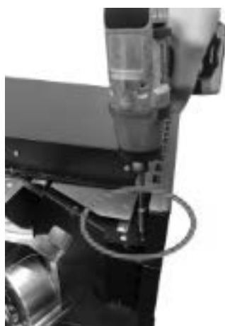
Fig. 60 - Fixation avant du tiroir
