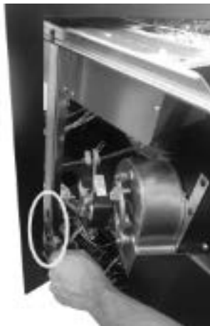
Fig. 27 - Desserrer les vis
