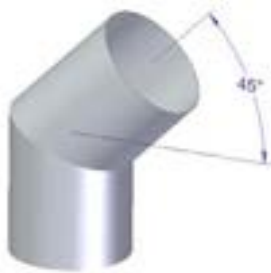
Figure 1 - Inclinaison correcte pour les tuyaux coudés
