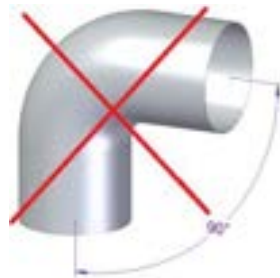
Figure 2 - Inclinaison incorrecte pour les tuyaux coudés
