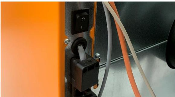
Actionnez l'interrupteur principal et le régulateur (touche On/Off,) (voir fig. a).
