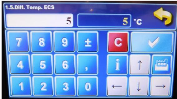
8- Le menu « 1.5.Diff. Temp. ECS » est la différence de température à laquelle la pompe d'alimentation du préparateur ECS démarre. Ici, elle est réglée à 5°C, soit un démarrage à 45°C (50-5). Fig. h
