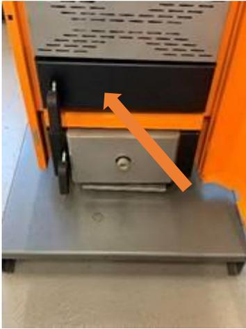
4- Ouvrir la porte de la chambre de combustion (Porte du milieu). Fig. d
