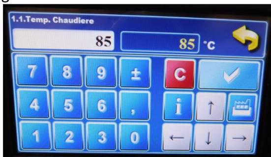
4- Le menu « 1.1.Temp. Chaudière » est la température maxi de la chaudière. Sur l'illustration, elle est réglée à 85°C. Fig. d
