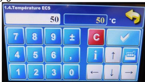
7- Le menu « 1.4.Température ECS » est la température à laquelle la pompe d'alimentation du préparateur ECS s'arrête. Sur l'illustration, elle est réglée à 50°C de consigne. Fig. g
