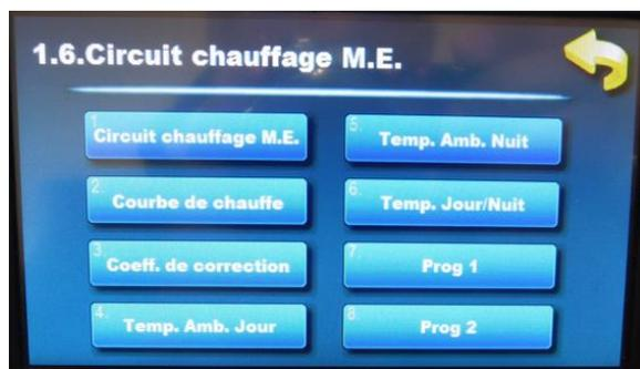
2- Sur le menu « 1.6.Circuit chauffage M.E. », appuyer à nouveau sur « Circuit chauffage M.E. ». Fig. b
