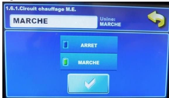
3- Sur le menu « 1.6.1.Circuit chauffage M.E. », vous pouvez activer ou désactiver votre circuit de chauffage. Fig. c
