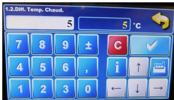
5- Le menu « 1.2.Diff. Temp. Chaud. » correspond au delta de redémarrage de la chaudière. Fig. e
