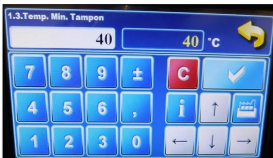
6- Le menu « 1.3.Temp. Mini Tampon » est la température à laquelle les pompes des circuits de chauffage pourront être activés. Ici, elle est réglée à 40°C. Fig. f
