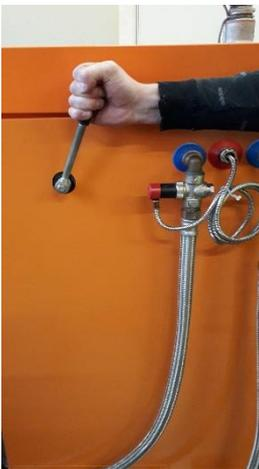
6- Manipuler en va et vient plusieurs fois la poignée latérale en fonction de l'encrassement des échangeurs. Fig. f
