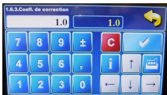
5- Sur le menu « 1.6.3.Coeff. de correction », vous pouvez ainsi changer le degré de correction. Ici le coefficient est réglé à 1. Sur le correcteur d'ambiance - CSK, chaque graduation correspondra approximativement à 1°C.
