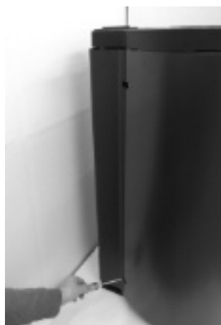
Fig. 74 - Dévisser les vis latérales
