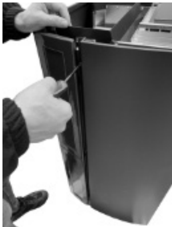
Fig. 47 - Retirer les vis
