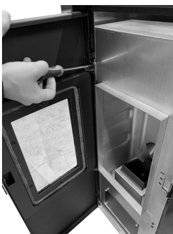
Fig. 32 - Retrait des vis
