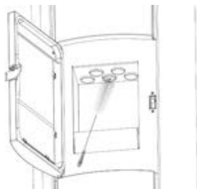
Fig. 23 - Nettoyage des faisceaux tubulaires
