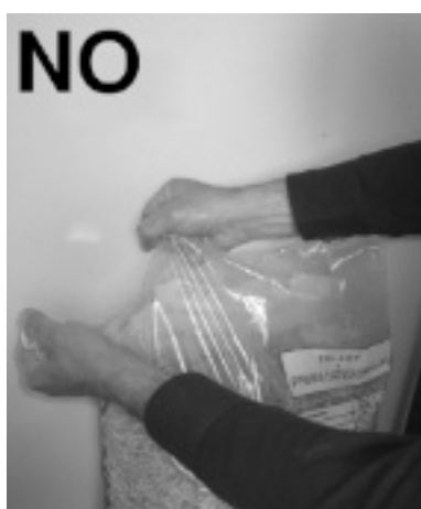
Fig. 13 - Ouverture incorrecte du sac des granulés
