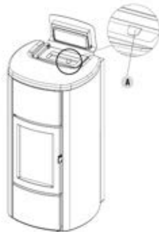
Fig. 22 - Levier pour le nettoyage des turbulateurs (Idro Prince 3 16-23-23 H2O, Aquos 3 16-23-23 H2O, Idron 16-22 Airtight, Hidrofire 22.8)
