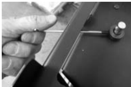
Fig. 91 - Dévisser la vis avec une clé de 2,5
