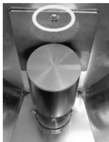
Fig. 97 - Retrait des vis
