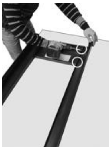
Fig. 21 - Fixation de montant
