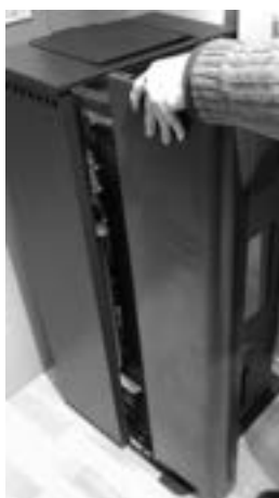
Fig. 30 - Accrocher le cadre au poêle dans les encastements
