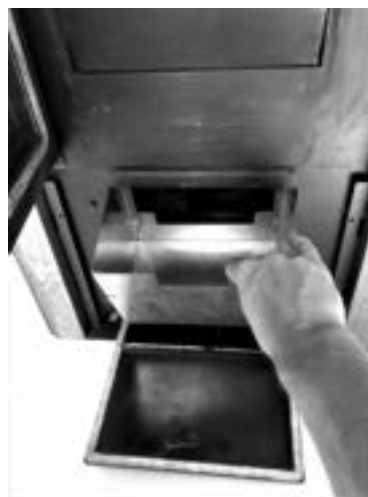
Fig. 80 - Retirer le bouchon d'inspection
