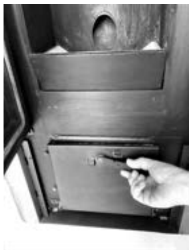
Fig. 79 - Retirer les vis
