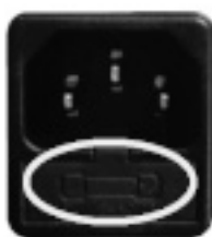
Fig. 95 - Hublot avec les fusibles à enlever
