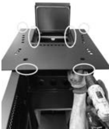
Fig. 47 - Retrait des vis
