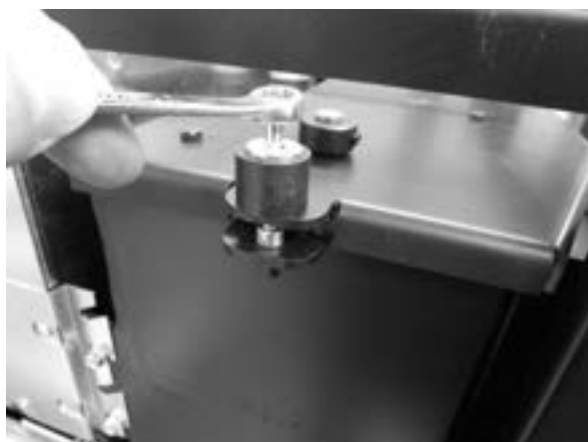
Fig. 90 - Dévisser la vis avec une clé de 8
