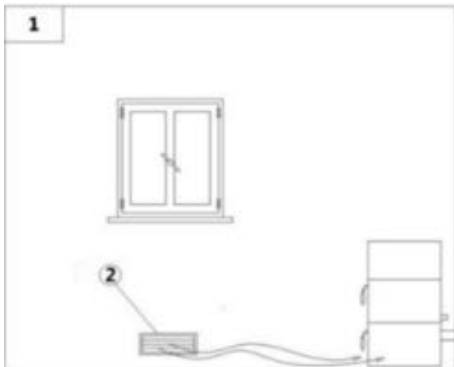
Fig. 11 - Entrée d'air directe
