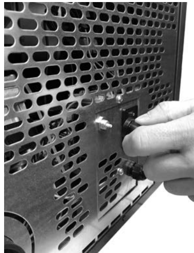
Fig. 31 - Réarmement manuel: MODO AIRTIGHT e QUASIMODO 3 UP
