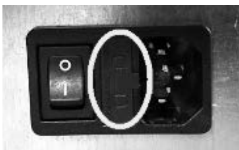
Fig. 81 - Hublot avec les fusibles à enlever
