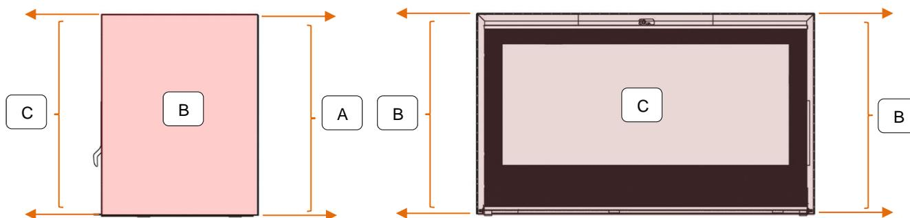
Pour les inserts, ces distances incluent une isolation en laine de roche épaisseur 30mm. La lame d'air de convection présente entre le foyer et l'isolant est strictement nécessaire à la bonne ventilation de l'appareil.
