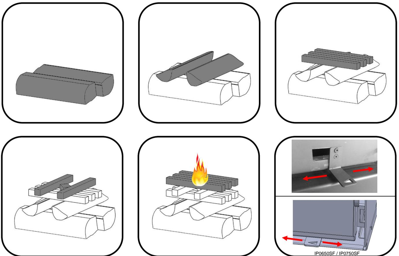
L'allumage de l'appareil doit être réalisé suivant le procédé d'allumage inversé décrit ci-dessus. Cela permet une montée en température progressive de l'appareil et des conduits et un amorçage du tirage facilité.
