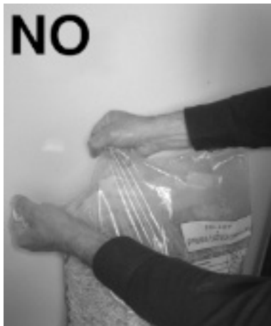
Fig. 22 - Ouverture incorrecte du sac des granulés
