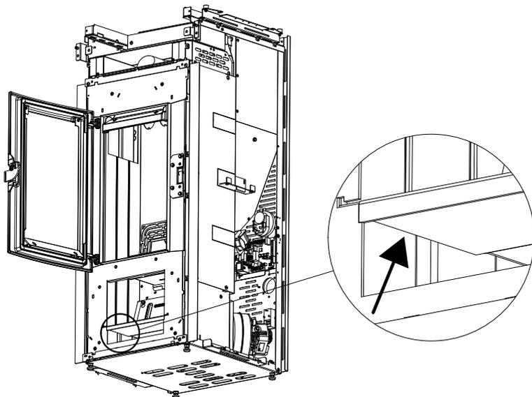
À l'aide d'une tige rigide ou d'une brosse pour bouteilles, gratter les parois du foyer (voir la flèche - respectivement à droite et à gauche du foyer) en correspondance des plaques « S » qui viennent d'être retirées de façon à laisser tomber les cendres dans le compartiment inférieur.
