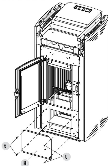
Desserrer les quatre vis « **y** », enlever la plaque « **n** » et le joint « **o** » ; avec le bec de l'aspirateur, ôter les cendres et la suie accumulées dans l'échangeur inférieur (extracteur de fumées) indiqué par la flèche.
