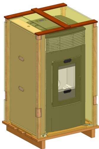
EMBALLAGE DU POËLE AVEC REVÊTEMENT EN MÉTAL
