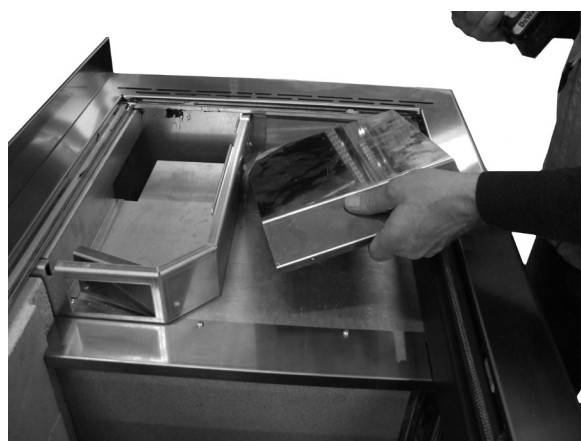
Fig. 22 - Retirer le déflecteur
