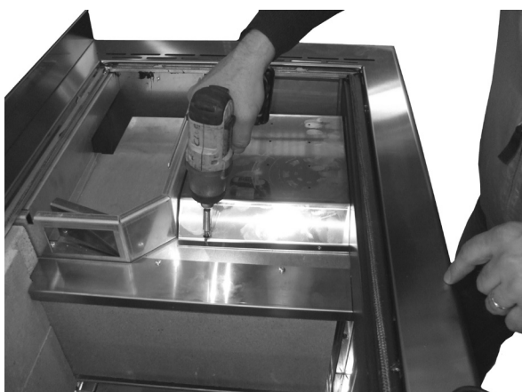
Fig. 21 - Retirer les vis
