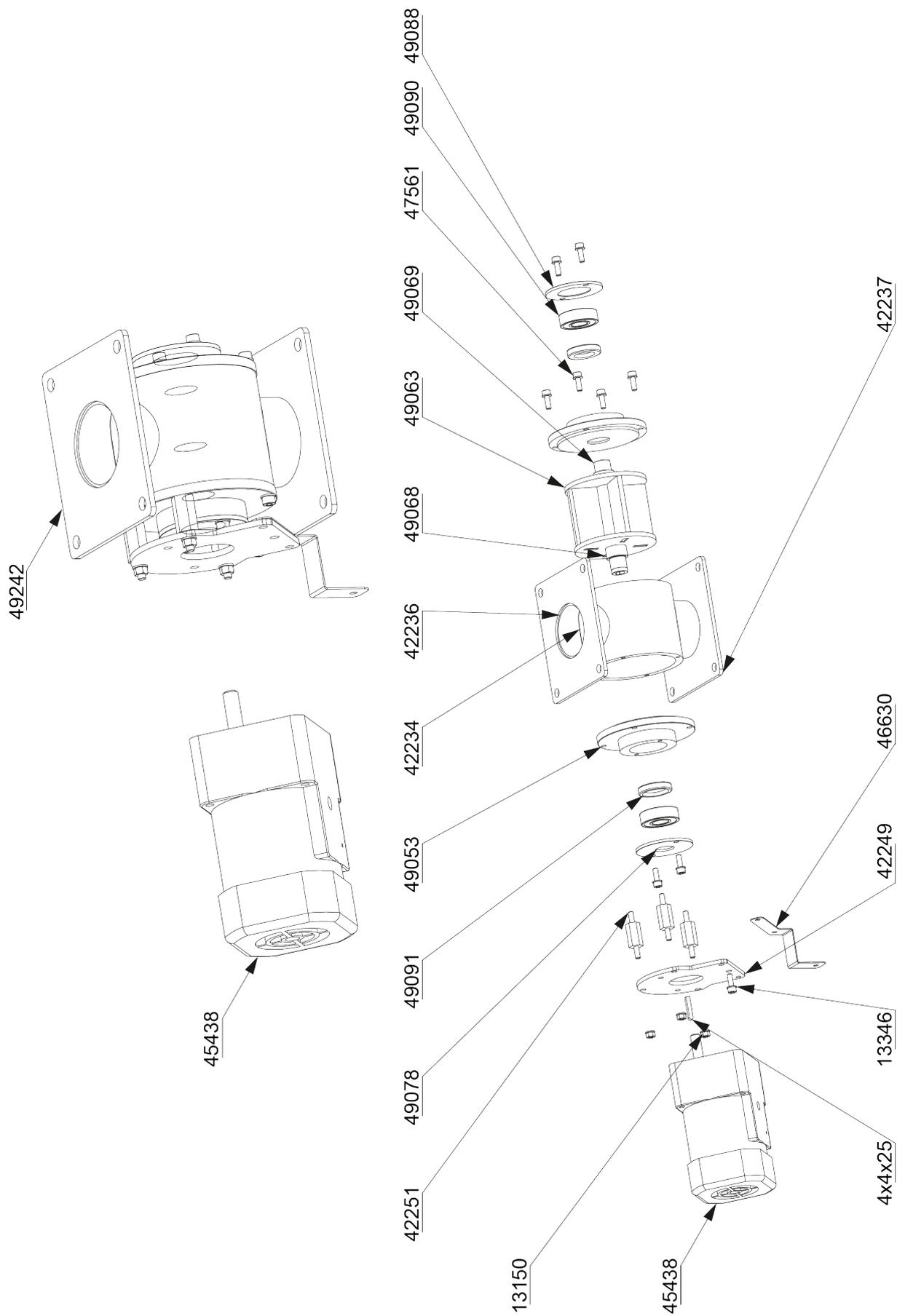
VUE ÉCLATÉE DE LA CHAUDIÈRE GMX EASY 45 - côté - GRANULÉS - capot de la chambre de combustion des granulés
