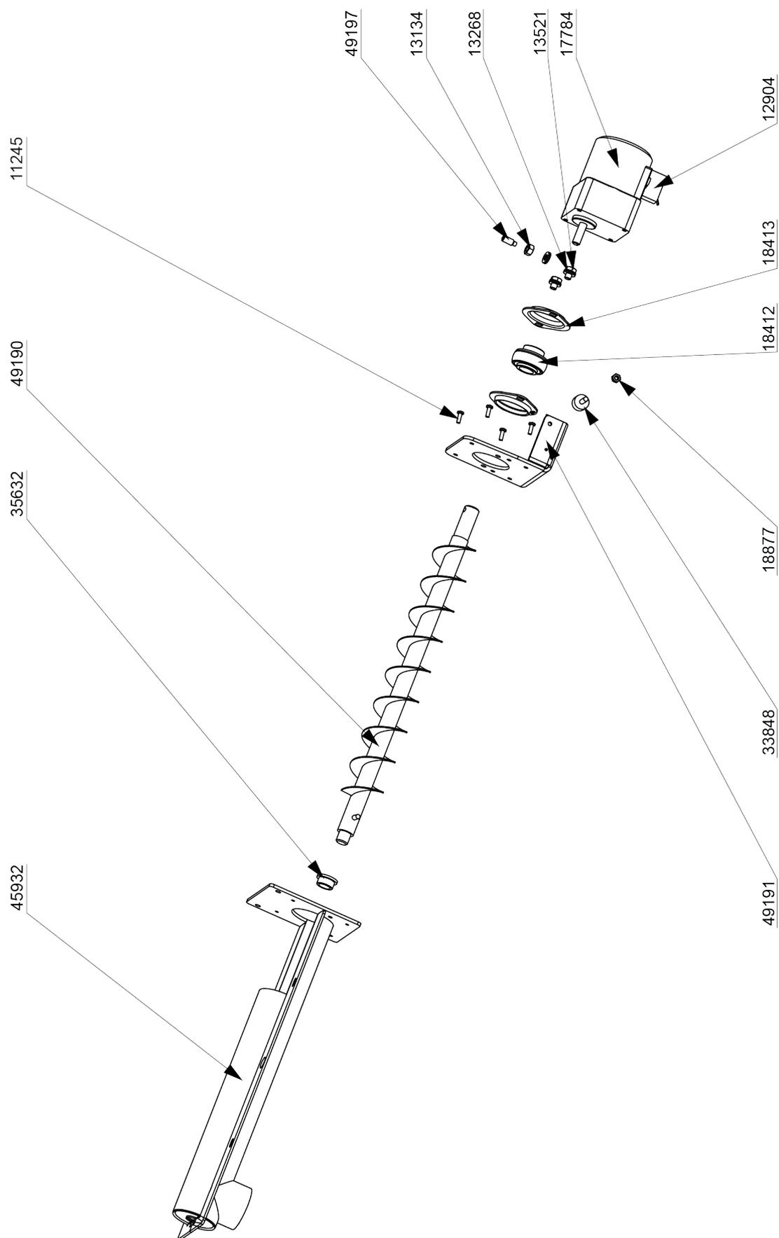
VUE ÉCLATÉE DE LA CHAUDIÈRE GMX EASY 45 - côté - GRANULÉS - vanne rotative de l'alimentation en granulés
