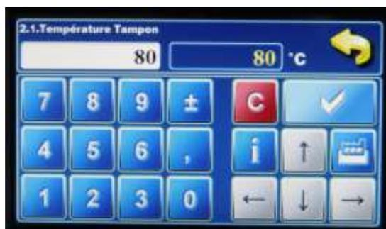
4- Le menu « 2.1.Température Tampon » est la température maxi du ballon tampon. Sur l'illustration, elle est réglée à 80°C. Fig. d
