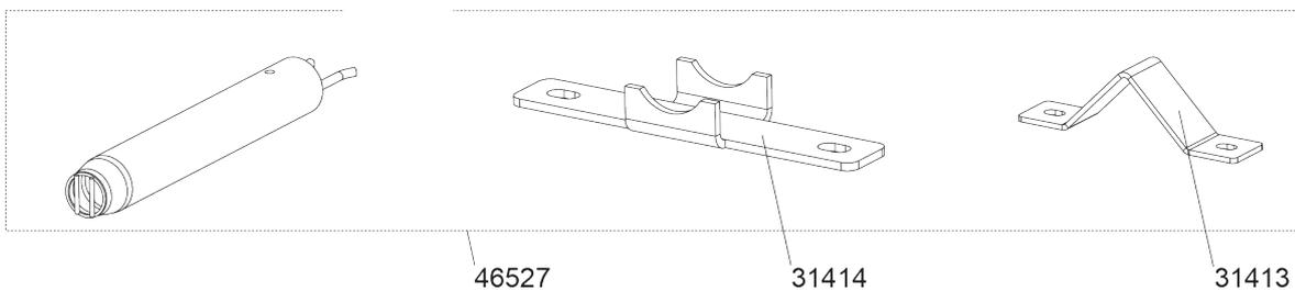
2ème et 3ème turbulateurs de passage des gaz de combustion - assemblage - GM EASY 18
