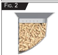
**Phase 2:** allumer. Après la charge automatique, lors de la phase d'allumage de la résistance, la quantité de pellets ne doit jamais dépasser le niveau indiqué (vedi Fig. 2) pour éviter le risque d'allumage pas conformes.
