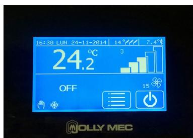
Ce display permet d'afficher les principaux paramètres de l'appareil, de régler les paramètres désirés de fonctionnement, de programmer les allumages et les extinctions, et d'afficher les éventuelles alarmes d'anomalies de fonctionnement.
