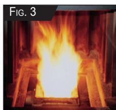
**Phase 5:** dans le cas d'une combustion incorrecte ou de problèmes d'allumage, procéder à un nettoyage général de la corbeille en respectant les instructions contenues dans le manuel.
