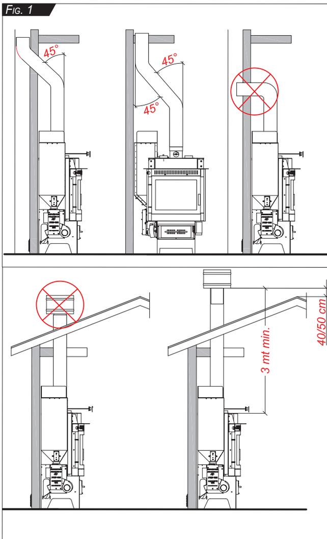
Si le conduit de fumée est installé à l'extérieur, il est impératif qu'il soit isolé afin d'éviter le refroidissement des fumées et la formation de condensation. Même procédure pour la partie allant du toit au chapeau de cheminée.
