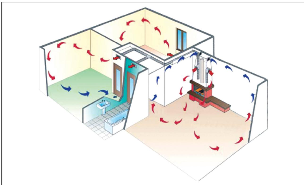
Pour la distribution de l'air chaud dans plusieurs pièces ou locaux, monter le raccord en T ou en Y (option) en plus de raccorder les bouches sur le revêtement.
