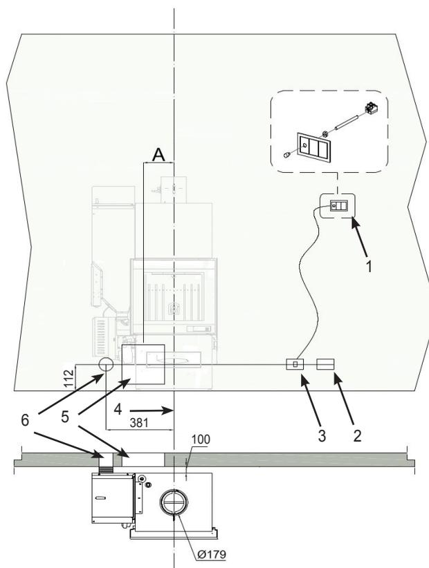
La cheminée peut fonctionner en prélevant l'air de combustion de la pièce où la cheminée est installée ou directement de l'environnement extérieur. Dans le premier cas, il convient d'assurer le changement de l'air à travers la réalisation de la prise d'air extérieure **5**. Dans le deuxième cas, il convient de canaliser l'air de la cheminée en la connectant aux prise de l'air de combustion **6**, ce qui rend inutile la réalisation de la prise d'air extérieure **5**.
