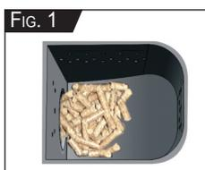
**Phase 1:** charger manuellement une petite quantité de pellet à l'aide de la commande de l'écran (voir Fig. 1) en cas de premier allumage. Ne pas dépasser la dose conseillée et s'assurer que le brasier est bien bloquée en la forçant à l'aide de la vis appropriée.
