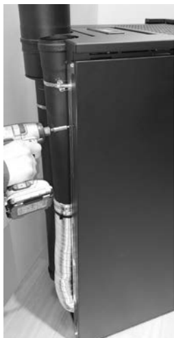
Fig. 28 - Retirer les vis.
