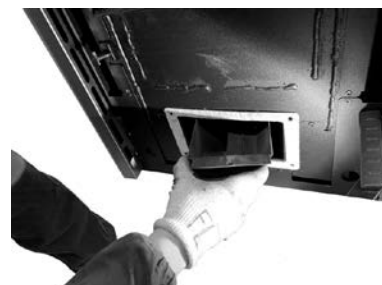
Fig. 94 - Ôter le déviateur de fumées
