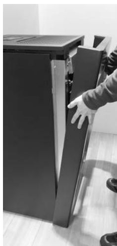
Fig. 32 - Retirer le cadre
