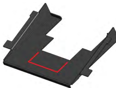
Figure n°8 - Les marques sur le déflecteur
